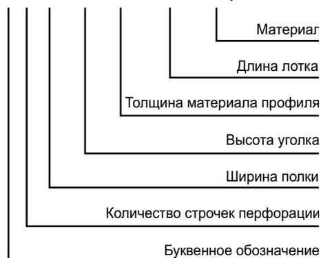
Перфуголок перфорированный по одной полке, ширина и высота - 32 мм, толщина материала профиля - 1,5 мм, длина - 2500 мм, из оцинкованной стали.
